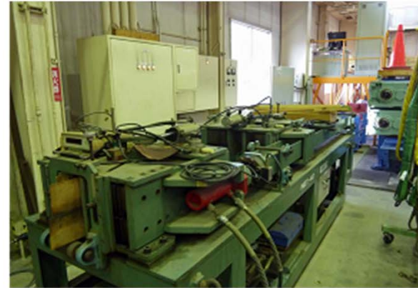
独立行政法人森林総合研究所所有の40トン木材引張試験装置
