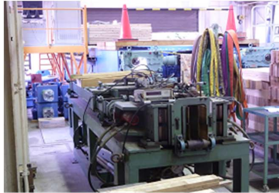
独立行政法人森林総合研究所所有の40トン木材引張試験装置
