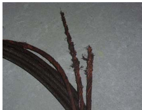
図2 ロープA、B破断部
