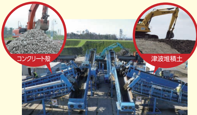
①混合機で津波堆積土とコンクリート殻を一定比率で混合。 ※環境省通知に基づき、津波堆積土の安全性が確認されたものを活用しています。
