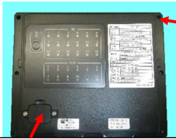
ラジコン受信機+制御ユニット
