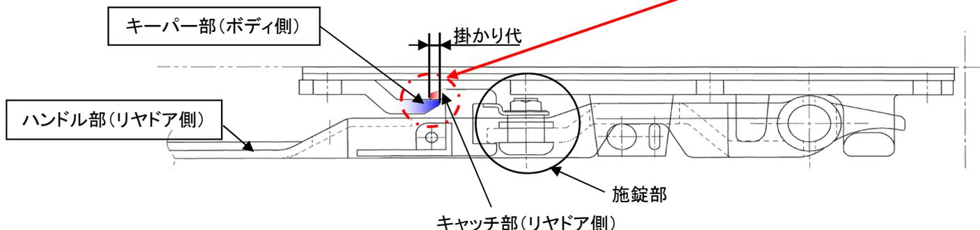
ウイングボデーのスチール製アンダーロック式リヤドアハンドル仕様車において、リヤドアハンドルのキャッチ部とキーパー部の掛かり代が不足しているものがある。そのため、リヤドアハンドルを閉めた後に施錠がされていない状態で走行した場合、走行中の荷台のねじれなどの影響によりキャッチ部が開く
