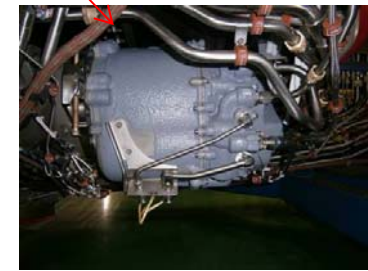
原因と考えられる発電機 (各エンジンに2個) (米国の部品製造者)
