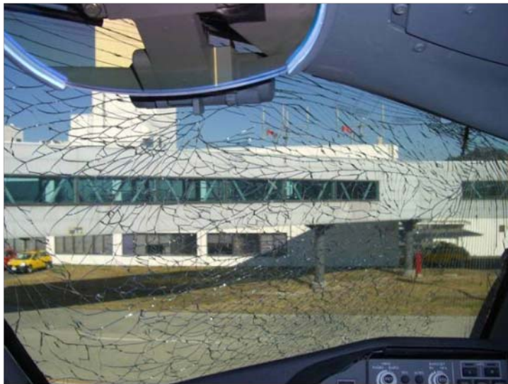
ひび割れした操縦室窓 (米国の部品製造者)
