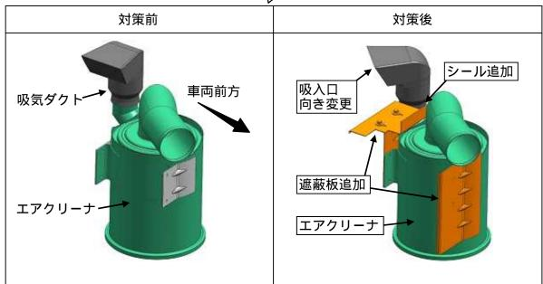
乗降性改善のためステップの奥行きを広くしたダブルキャブを搭載したトラックにおいて、吸気ダクトの吸入口への遮水性能が不足しているため、水溜り路・冠水路等を走行すると、当該吸入口より水が浸入することがある。そのため、エンジン内部に水が浸入し、最悪の場合、エンジンが停止するおそれがある。
