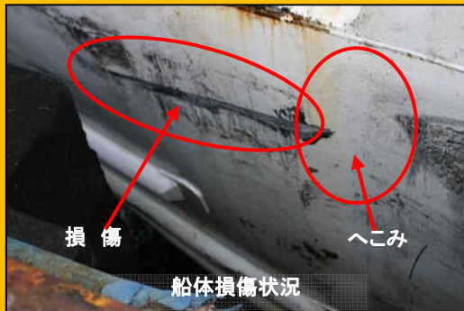
港内擾乱による被害状況
