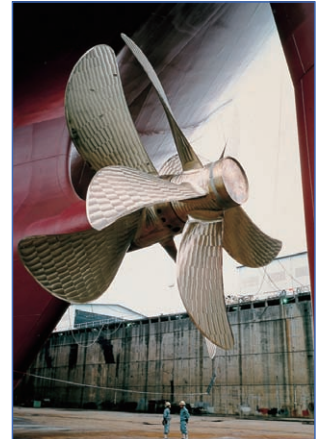
Contra-rotating propeller system 二重反転プロペラ
