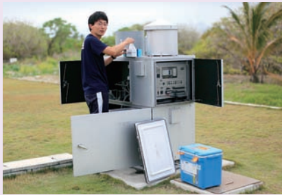
降水・降下じん採取装置の点検を行う。
