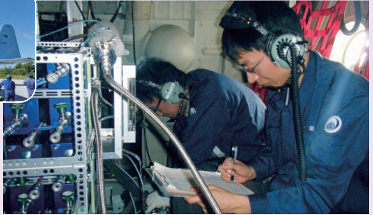
C-130輸送機を利用した上空の温室効果ガス観測。地球温暖化の予測精度向上へつなげる。
