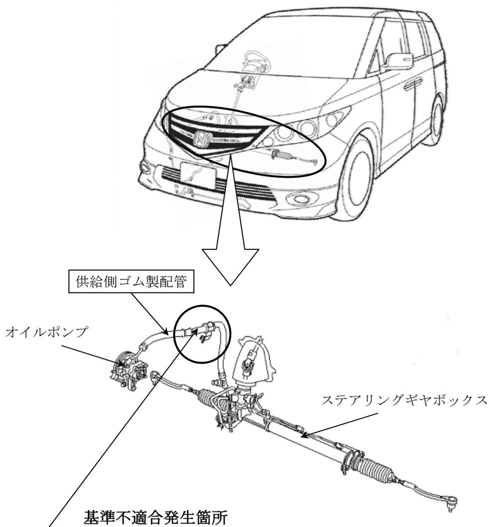
油圧式パワーステアリングの供給側ゴム製配管の耐熱性が不足しているため、排気管の触媒コンバータの熱でゴム製配管が劣化して柔軟性が低下するものがある。そのため、ハンドル転舵時の油圧変動でゴム製配管に亀裂が生じてパワーステアリングオイルが漏れ、最悪の場合、排気管に付着し火災に至るおそれがある。
