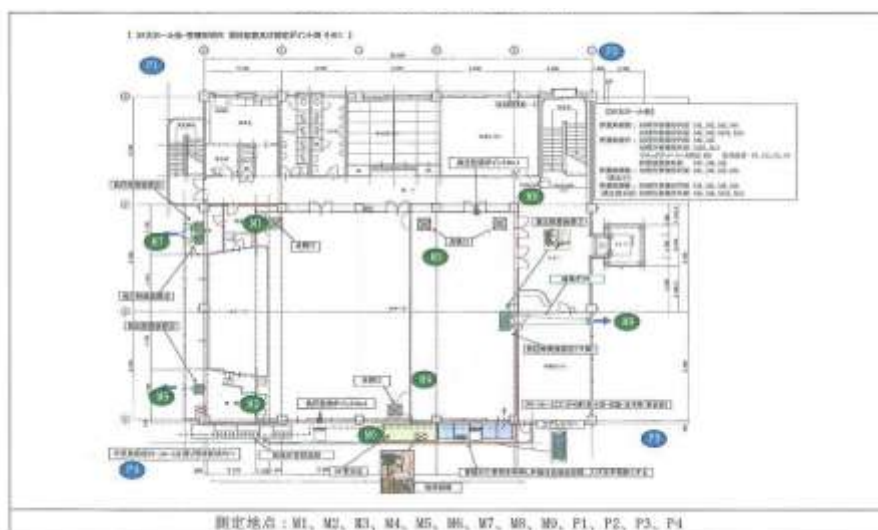
図 25 石綿粉じん気中濃度測定位置図（1工区（3階大ホール））
