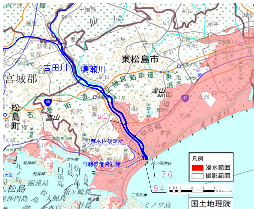
図 1-11 津波による浸水範囲 (鳴瀬川)
