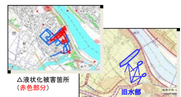
液状化被害(左)と地形分類(右)との関係例旧水部の埋立地で被害が集中
