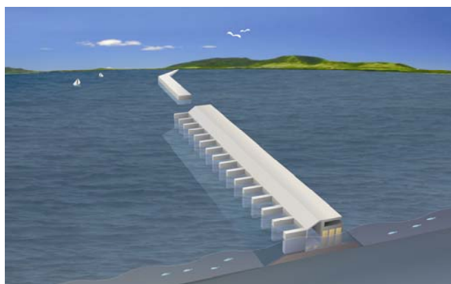
〈防波堤組込型高効率波力発電システムの概念図〉
