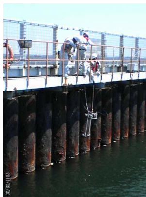
<無人による鋼管肉厚計測>
