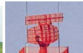
【空港監視レーダー】
