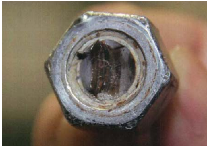
写真4 破断したボルトの破断面とナット表面の状況
