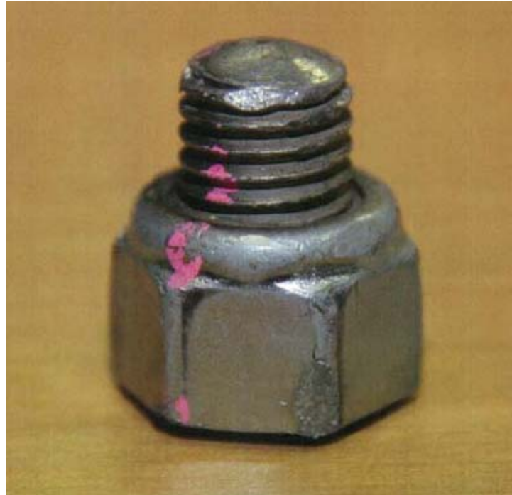
写真3 破断したボルトの先端部とナット
