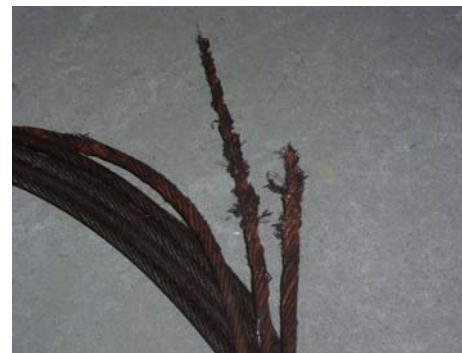
図2 ロープA、B破断部
