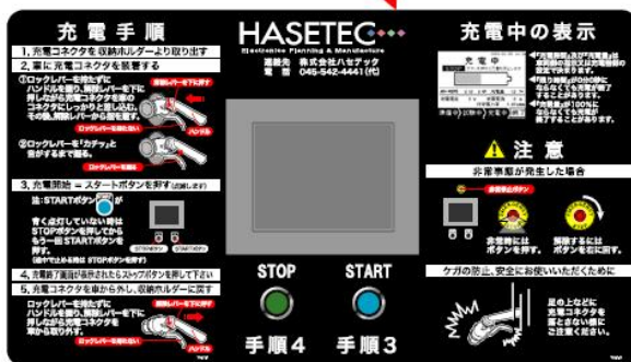
写真 4-12 急速充電器本体の操作説明表示(例)
