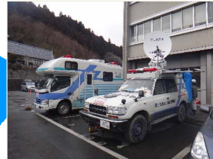
衛星通信車による通信回線の確保
