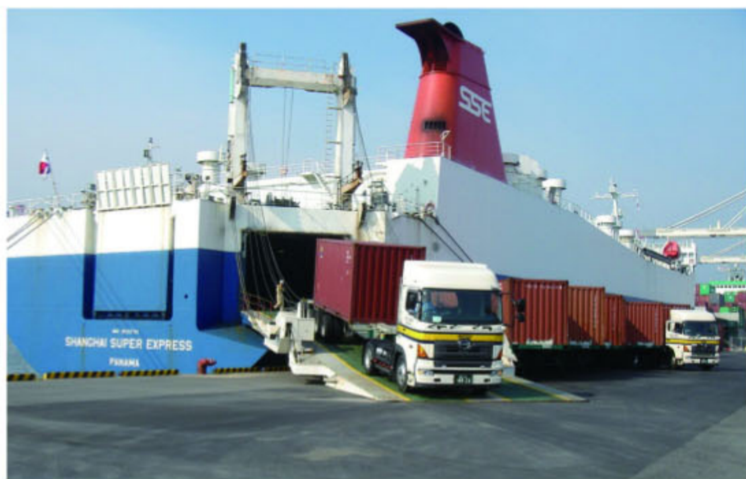
現在は敦賀港・下関港から韓国・中国に航路が開かれている国際RORO船。ROROとはRoll-On/Roll-Offの略で、トレーラーなどを収納する車両甲板を持ち、クレーンなどを使わず自走により積み下ろしする荷役方式の貨物船のこと。
