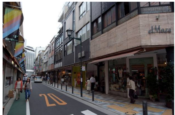
ブルバール街。1階後退部分と道路をまたぎ官民一体の歩道空間を確保している。
