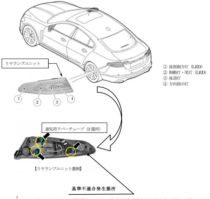
リヤランプユニットにおいて、通気用ラバーチューブに含まれる硫黄成分が水分を含んだ温かい通気と反応し、 LED電気基盤を腐食させる硫化ガスが発生する。そのため、LEDを使用している制動灯及び尾灯の電気基盤 が腐食し、制動灯及び尾灯が部分的に点灯しなくなるおそれがある。
