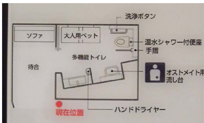
文字による表示をすることで多機能トイレ内の設備をわかりやすく表示
