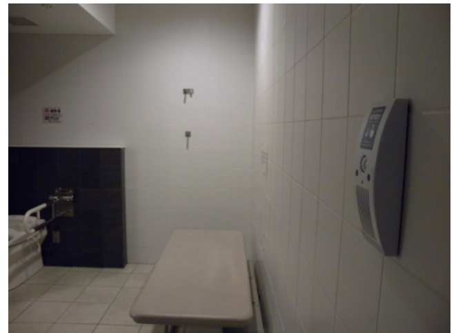
みんなのトイレ：ゆとりあるスペースに汚物流し、大型ベッド等が配置されている。扉横には、トイレ内の設備を案内する音声案内が設置されている。
