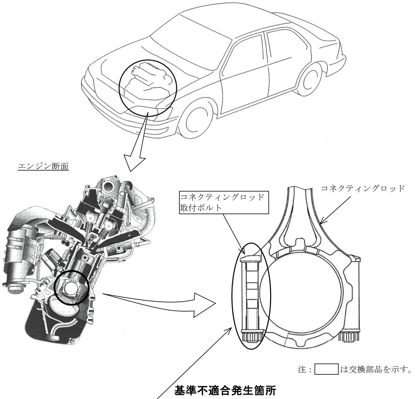
原動機内部のコネクティングロッド取付ボルトにおいて、強度が不足しているものがあるため、劣化したエンジンオイル中の成分の影響で当該ボルトが折損することがある。そのため、エンジンが破損して走行不能や、最悪の場合、火災に至るおそれがある。
