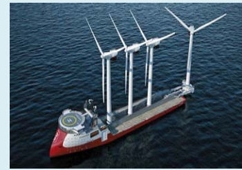
洋上風力の設置、メンテナンスに最適な作業船のコンセプト例
