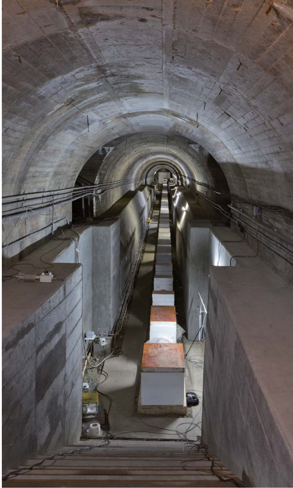
大抗道内の歪地震計。白く見えるのは水平方向の歪みを検知する石英管を支えている部分。歪地震計の左に平行して見えるのが、上下方向の歪みを検知する水管傾斜計の長い管。
