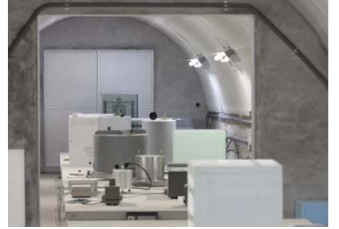
奥に見えるのが各種地震計。周囲からの震動を排除するための工夫が施されている。
