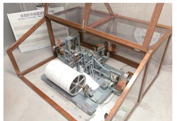
機械式1倍強震計は、1960年製造のアナログ式地震計。デジタル時代の現在でも、現役として活躍している。
