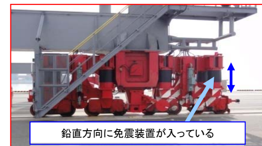
免震装置(走行部拡大)
