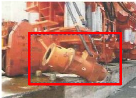
漂流物による走行モーターの損傷
