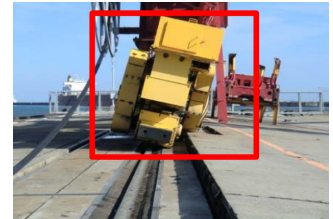
走行部の損傷
