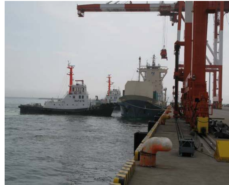
静穏度が確保されておらず、うねりの影響を受けるため、タグボート2隻で岸壁に押付け、荷役作業を実施
