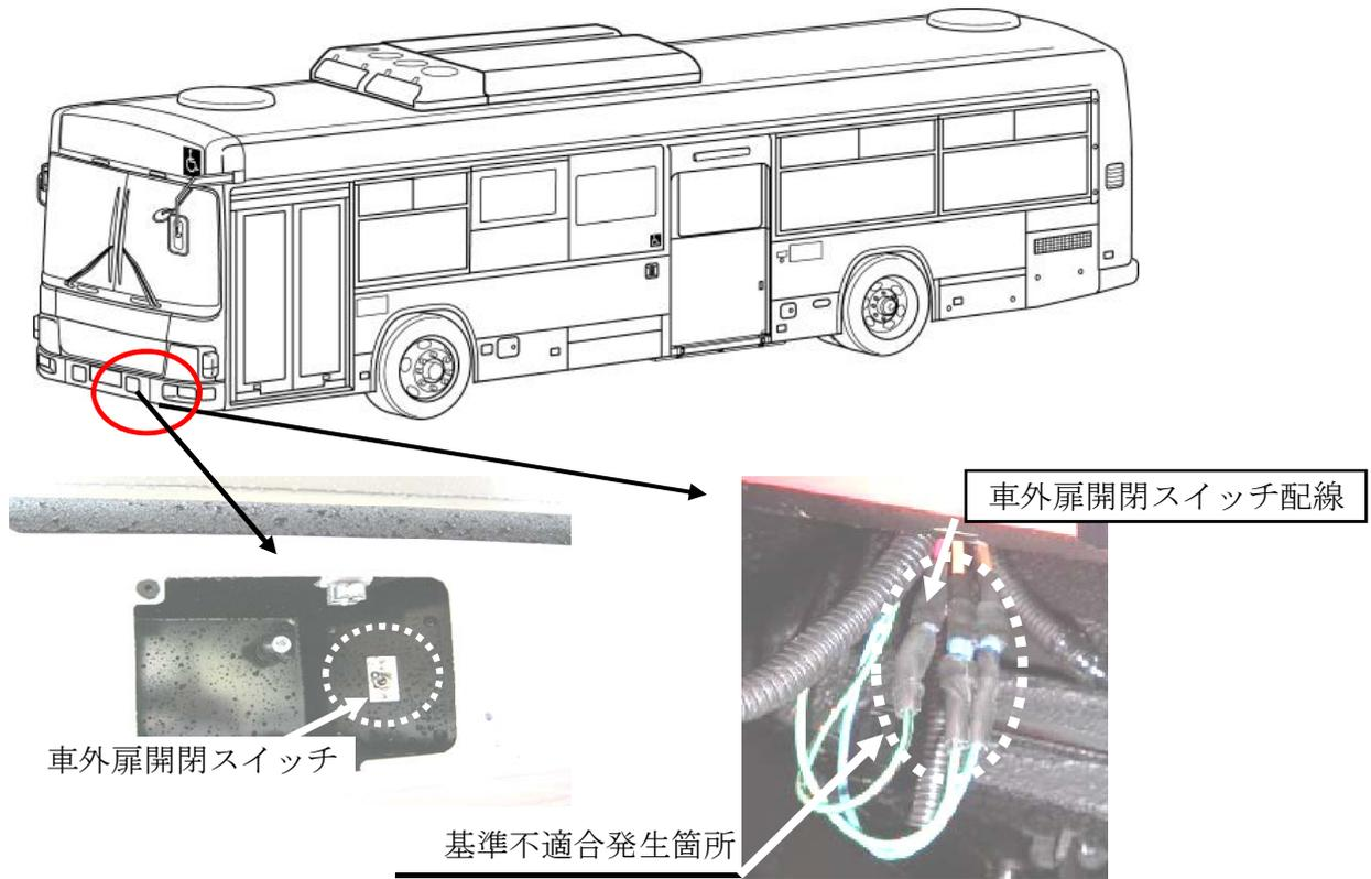
路線バスの車外扉開閉スイッチにおいて、当該スイッチ配線の接続部の防水処理が不適切なため、配線内部に水が浸入するものがある。そのため、そのままの状態で使用を続けると、当該配線が腐食・断線し、最悪の場合、車外扉開閉スイッチ及び運転者席の扉開閉スイッチで、扉の開閉ができなくなるおそれがある。
