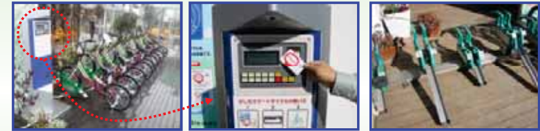
↑オートロックポート全体写真 ↑ICカードリーダーと専用ICカード ↑オートロックポートのラック
