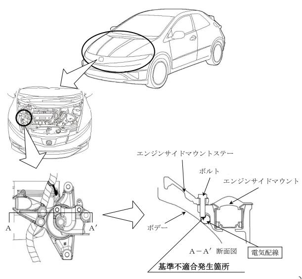
エンジンサイドマウント取付け作業時に、締め付けボルトで電気配線(エンジンルームワイヤーハーネス)の被覆を損傷させたものがある。そのため、走行中の振動で配線の被覆が破れて短絡すると、右側前照灯、前部霧灯、車幅灯、制動灯の不灯及び警音器が不鳴となるおそれがある。
