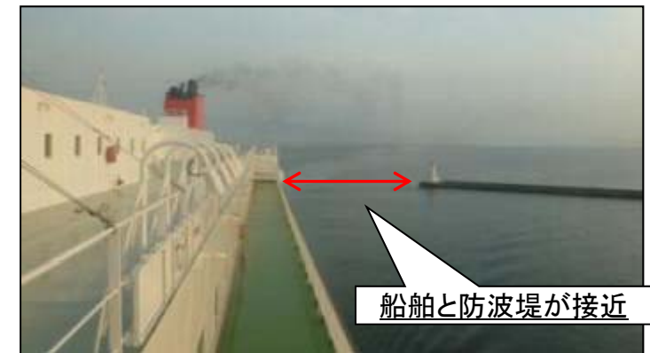
入出港時の防波堤への接近状況
