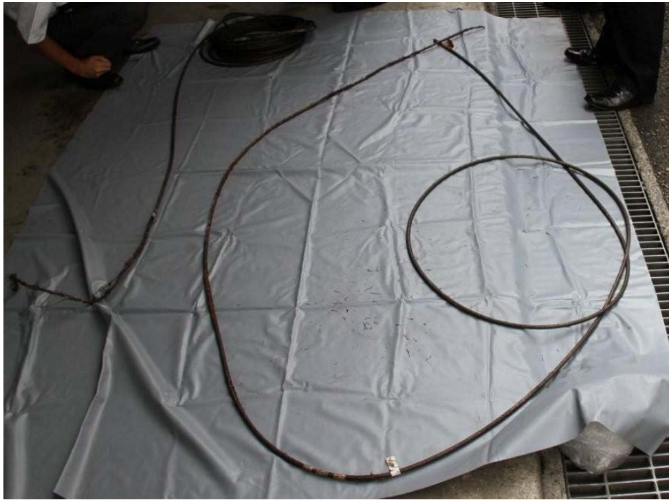
写真5 ロープC破断部からかご側
