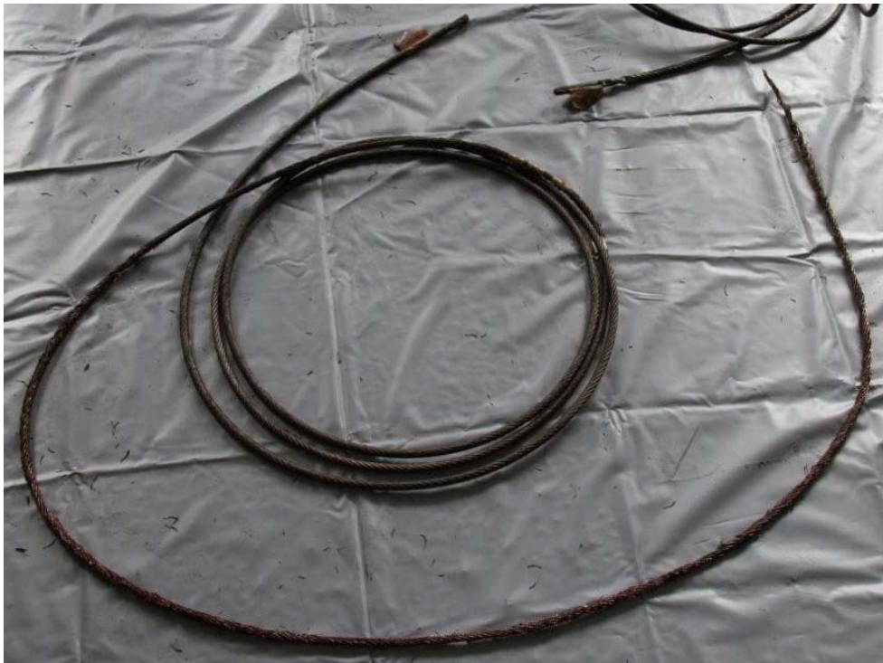
写真6 ロープC破断部からおもり側
