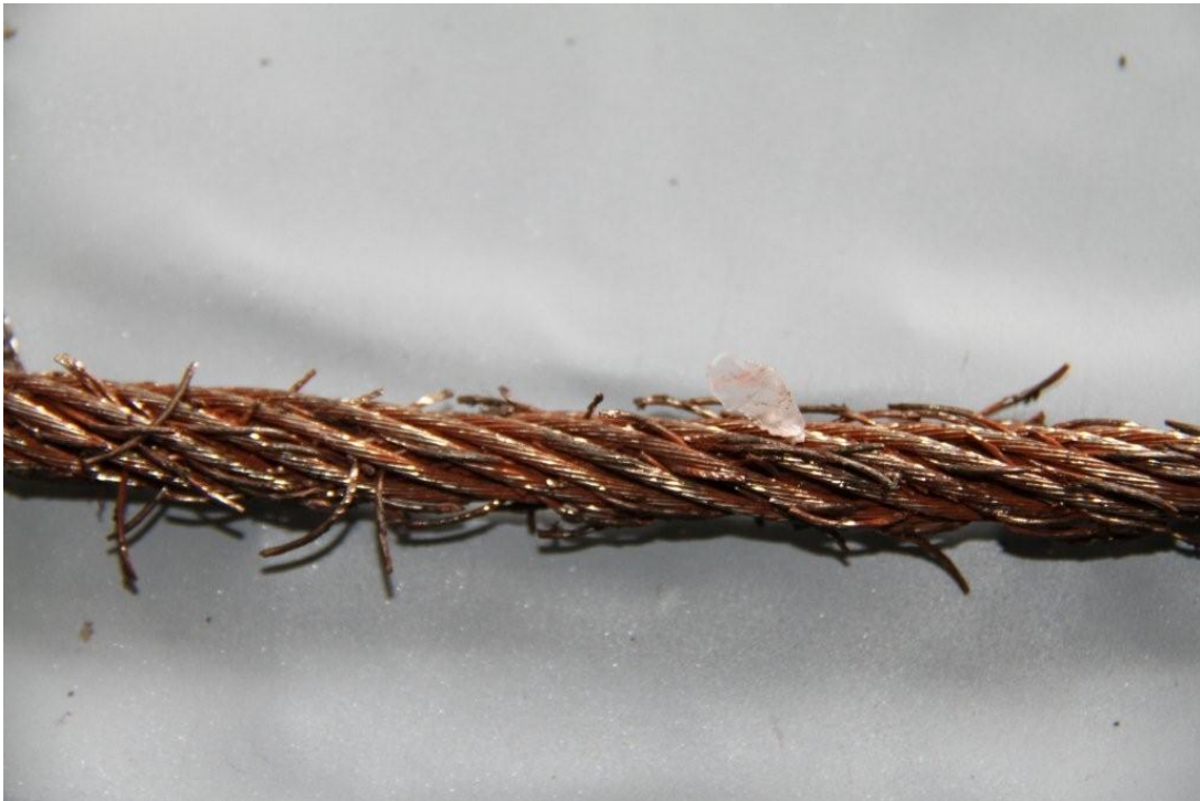
写真8 ロープC破断部近傍
