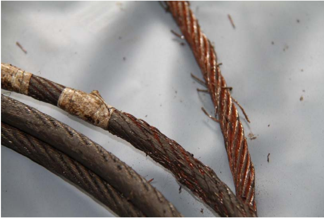
写真7 ロープC素線破断開始位置近傍
