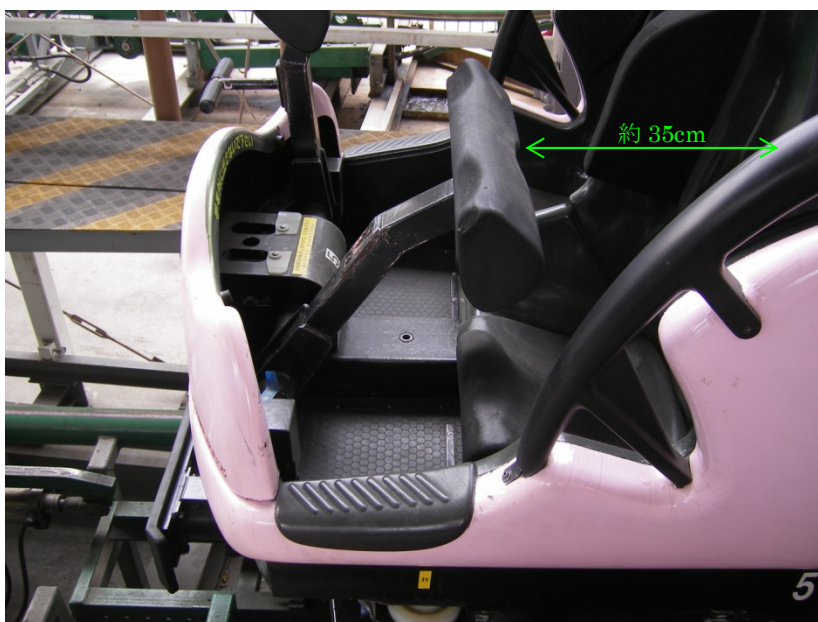
写真2 座席の安全バーを下げてラチェットの最初の歯が爪に掛かった状態
