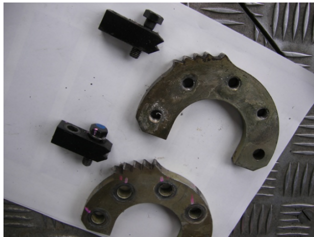
写真4 事故発生した座席のラチェットの歯と爪の状態
