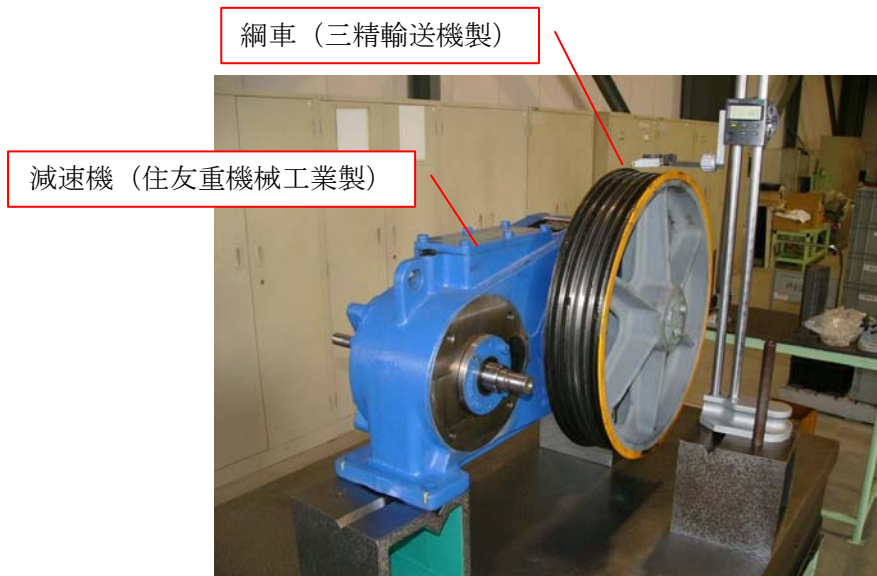
図3 減速機に綱車を取り付けた状態
