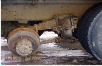
大型自動車の車輪脱落事故
