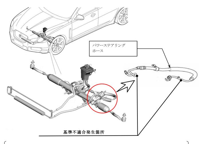
パワーステアリングの高圧ホースのパイプ部において、メッキ加工時間の管理が不適切であったため、被膜の薄いものが取付けられている場合がある。そのため、そのままの状態で使用を続けると、腐食により当該パイプ部にピンホールが発生し、パワーステアリングオイルが漏れて、操舵時に異音が発生し、操舵力が増大する。最悪の場合、飛散したパワーステアリングオイルがエンジンや排気管などの高温部にかかり発火するおそれがある。
