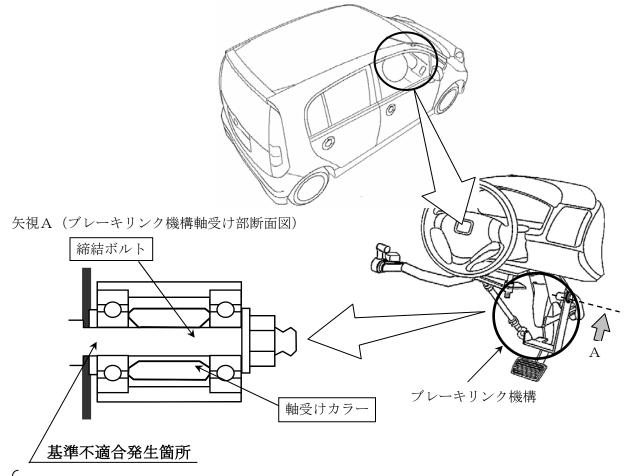
手動運転補助装置(ホンダテックマチック)装着車両において、ブレーキリンク機構の軸受け部の構造が不適切なため、軸受け部に過度な応力がかかるものがある。そのため、そのまま使用を続けると、軸受け部の締結ボルトに亀裂が生じ、最悪の場合、ボルトが折損してブレーキが効かなくなるおそれがある。
