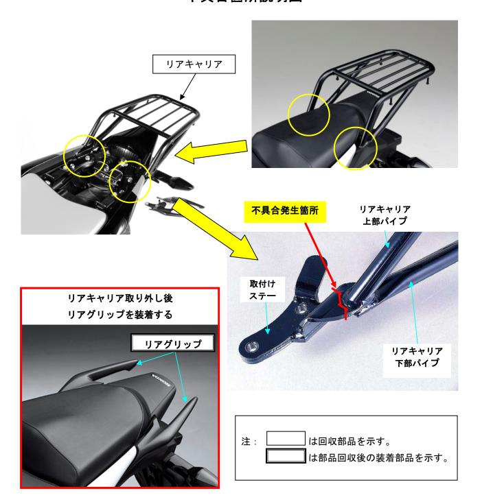
「後付け部品のリアキャリアにおいて、取付けステー部の設計強度が不適切なため、走行中の振動に」 より取付けステー溶接部付近に亀裂が発生する場合がある。そのままの状態で使用を続けると発生 \_した亀裂が進行し、最悪の場合、破損し脱落するおそれがある。
