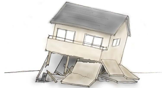
（基礎及び1階部分が崩れた住宅）
