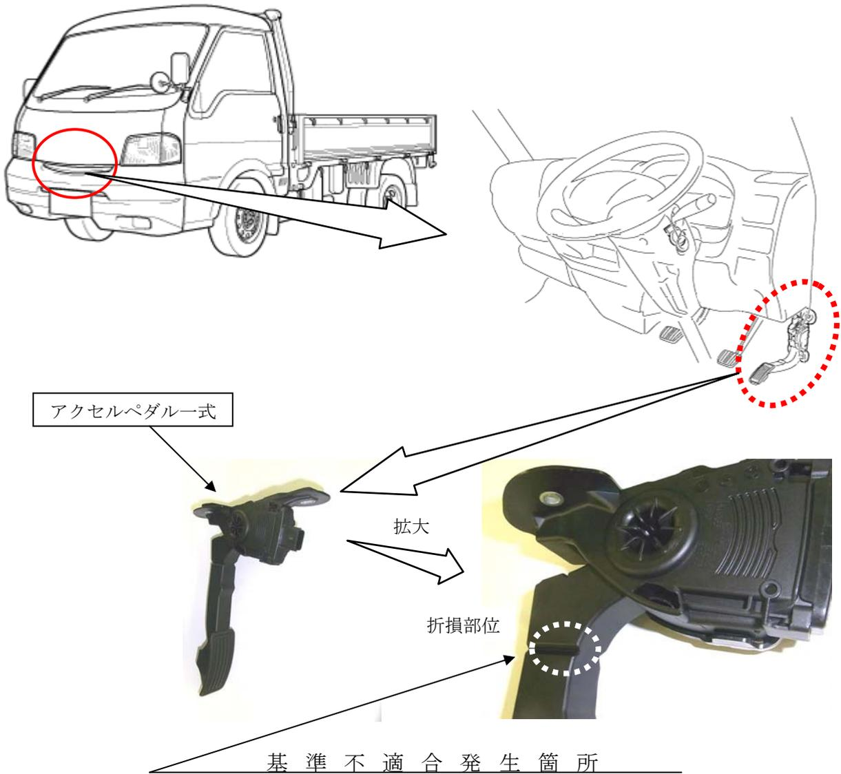
樹脂製アクセルペダルの強度が不足しているため、乗降時に足がペダルにひっかかるなどした場合にペダルアームに横方向の大きな荷重が加わると亀裂が入り、最悪の場合、ペダルアームが折損し走行できなくなるおそれがある。
