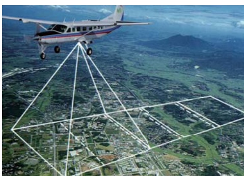
空中写真撮影を行う測量用航空機「くにかぜⅢ」。機体内部には大型カメラを設置。エリアごとに撮影を繰り返す。
