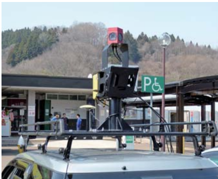
車両に搭載した全方位カメラで動画を撮影。道路の復旧後、日本測量機器工業会の協力で太平洋沿岸全域を走行して撮影を進めている。個人宅が映る場合もあるため一般公開はしていない。
