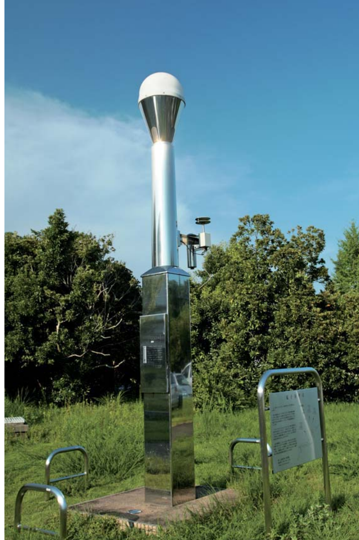
GPS衛星の電波を受信し、測地観測センターにデータを常時送信し続ける電子基準点。
