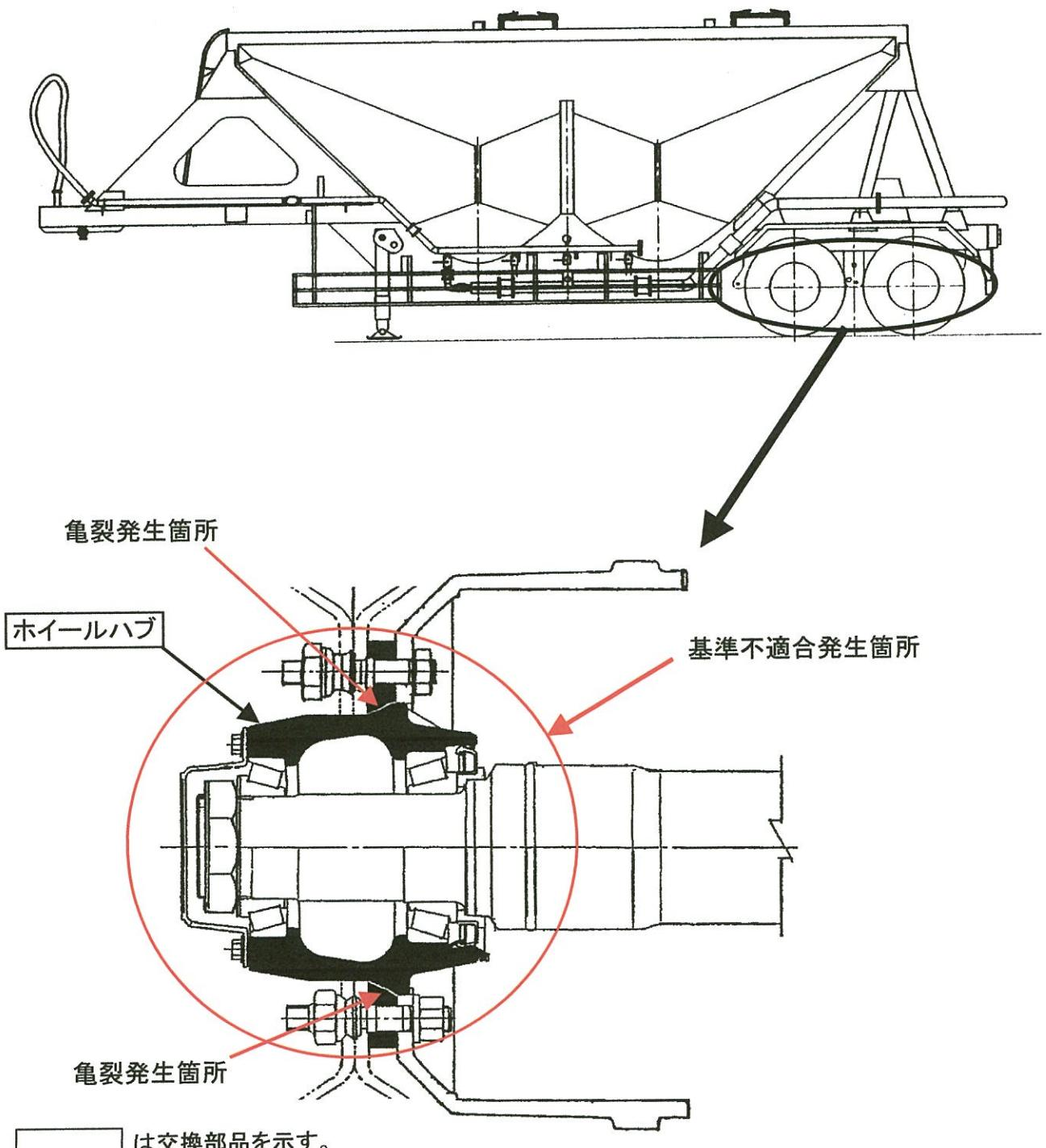
重心高が高い形状のセミトレーラにおいて、旋回時における車軸及びホイールハブに繰り返し作用する応力が大きくなることについての評価が不十分であったため、ホイールハブに亀裂が発生する場合がある。そのため、ホイールハブに亀裂がある状態で使用を続けると、ホイールハブが破損し、最悪の場合、車輪が脱落するおそれがある。
