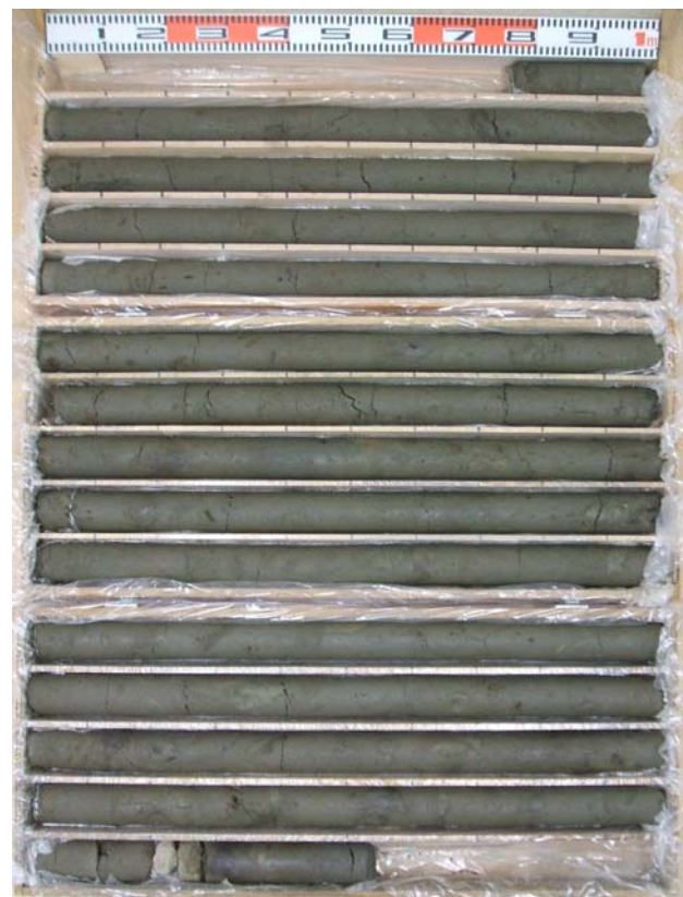
写真一 2 ボーリングコア
