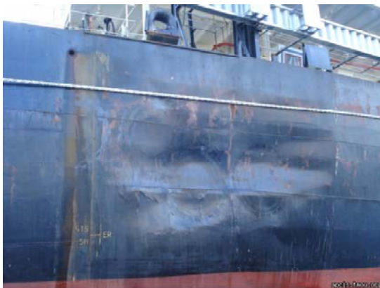
船舶の損傷例（写真：東京MOU提供）
