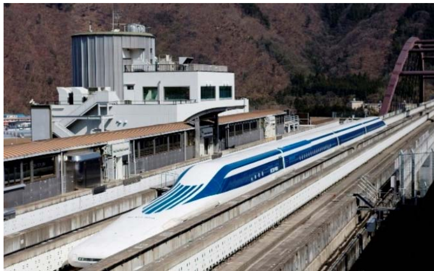
山梨実験センター及び走行試験中の超電導リニア車両
