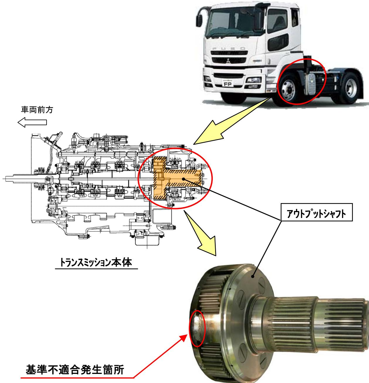
大型トラックにおいて、変速機のアウトプットシャフトの溶接が不適切なものがある。そのため、そのままの状態で使用を続けると、アウトプットシャフトの溶接部が破損し、最悪の場合、走行不能となるおそれがある。
