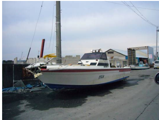
先端のみが損傷している船舶の例
