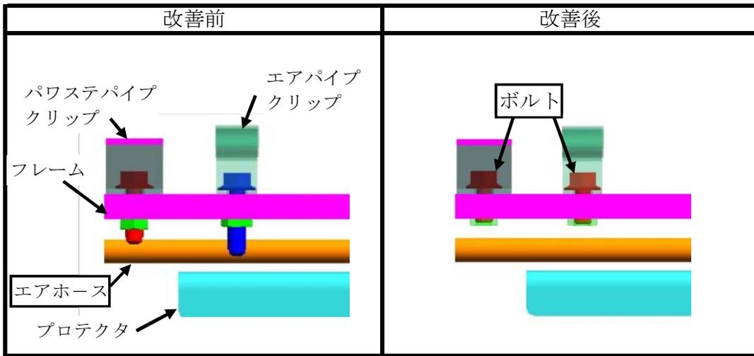
大型トラックのブレーキ用エアホースにおいて、当該ホースの取付け位置が不適切なため、エアパイプクリップ固定ボルトとプロテクタの間に挟まれるものがある。そのため、当該ホースに穴が開き、最悪の場合、制動力が低下するおそれがある。
