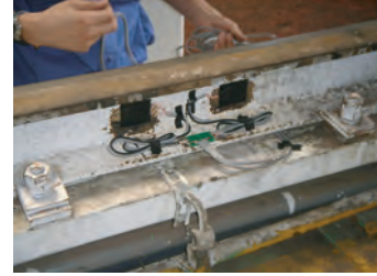
重量を検出するひずみゲージ
